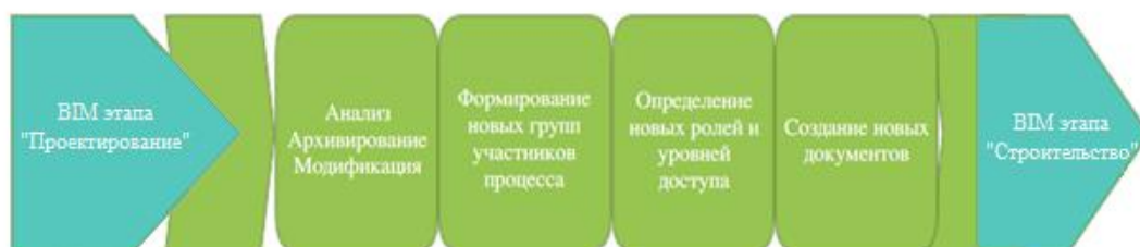
Рисунок 5.2 - Схема модификации BIM - модели для старта нового этапа жизненного цикла
