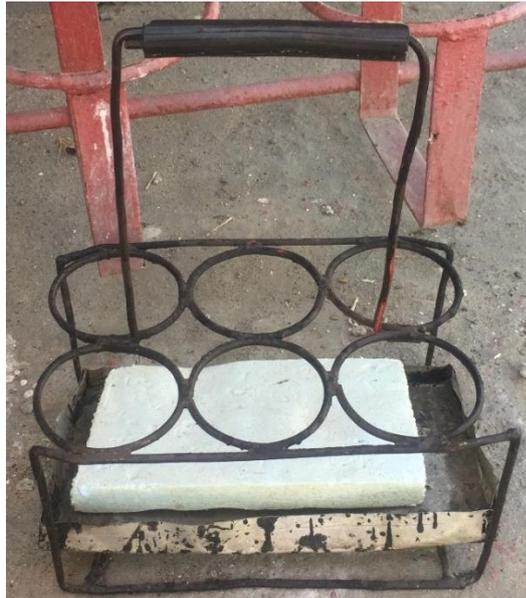
Рисунок 1 – Пример ручного переносного устройства для проб
